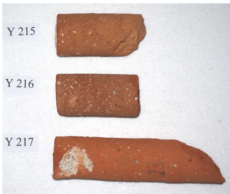
Obr. 1.: Vývrtky z cihel po dodání do laboratoře
